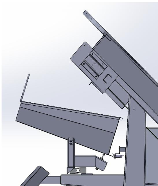
» LE TAPIS À TASSEUX DÉCALÉS PERMET DE MONTER LES COQUILLAGES UNIFORMEMENT POUR UN PESAGE PLUS PRÉCIS.
