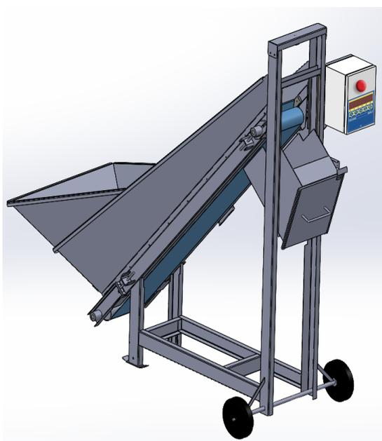
» LA VERSION ÉLECTRONIQUE POSSÈDE UN AFFICHEUR DIGITAL AINSI QU'UN VARIATEUR DE VITESSE, ET SA PRÉCISION DE PESAGE EST DE  $\pm 120$  GR.
